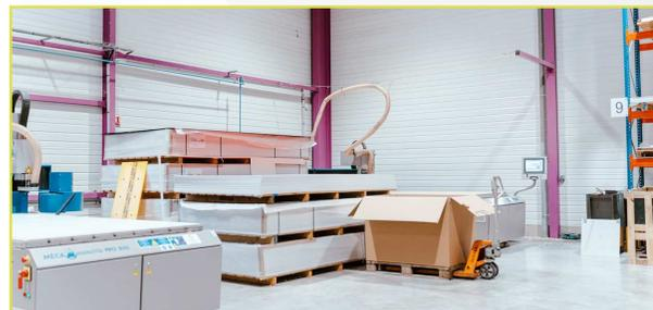
Nous disposons de deux tables à dépression permettant un excellent maintien des plaques pendant le fraisage pouvant aller jusque 3000 x 1500 mm ainsi que d'un chargeur de plusieurs outils rotatifs.
